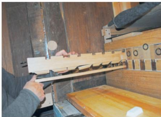
Die Springladentechnik ist eine Besonderheit der Orgel der Abteikirche Corvey.
