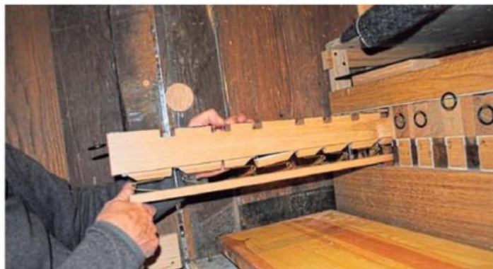
Die Springladentechnik ist eine Besonderheit der Orgel der Abteikirche Corvey. Weltweit gibt es nur noch sieben spielbare Orgeln mit dieser aufwendigen Technik.
